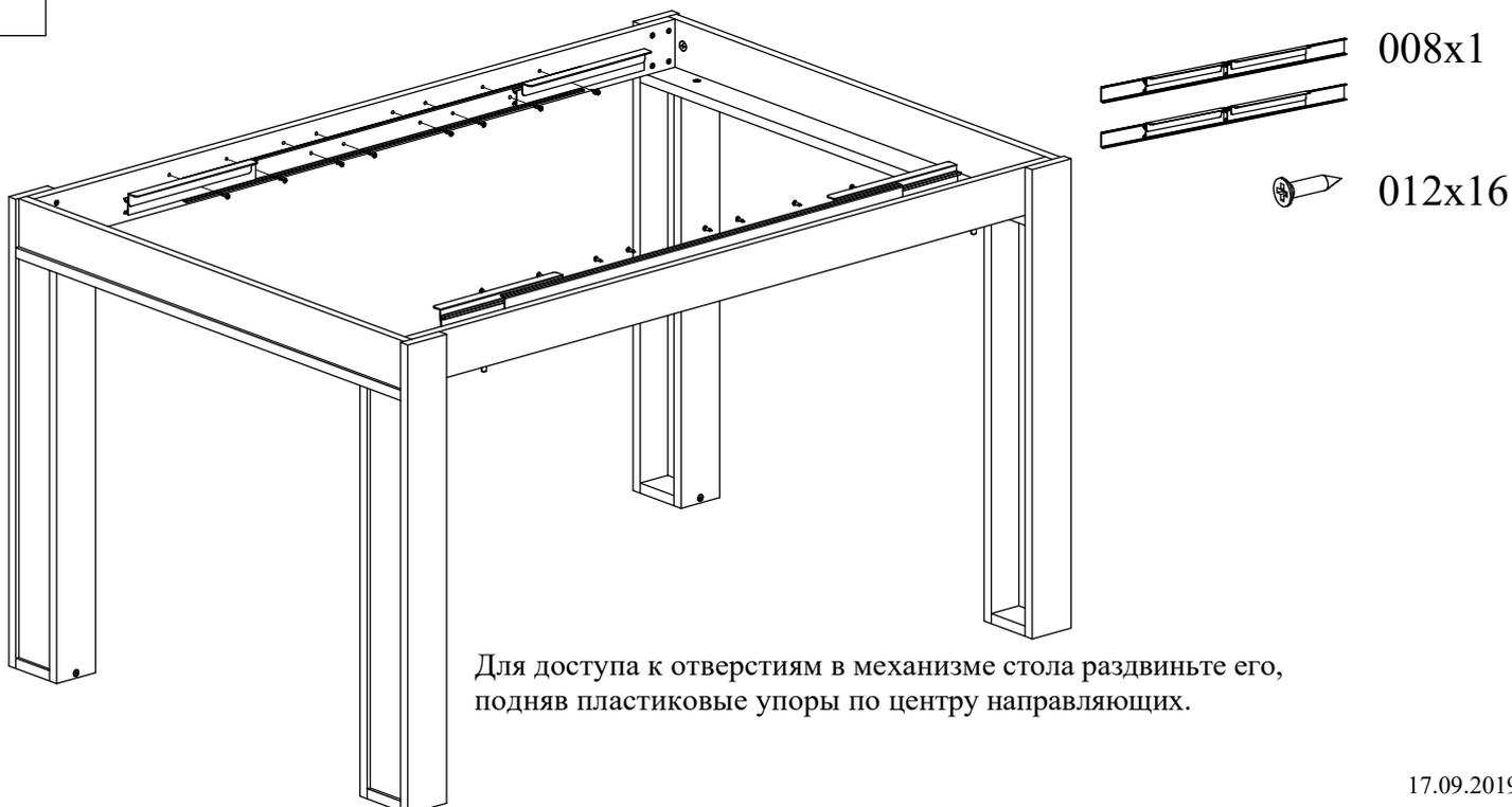
Для доступа к отверстиям в механизме стола раздвиньте его, подняв пластиковые упоры по центру направляющих.
